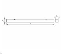
QUBBIC PX T5 - LINEAR - 1203 x 72 x 72 mm
